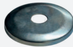
STEEL CAP FKK Ref. : 229.013 Outside Diameter : 86,8 Inside Diameter : 15 Height : 8,35
